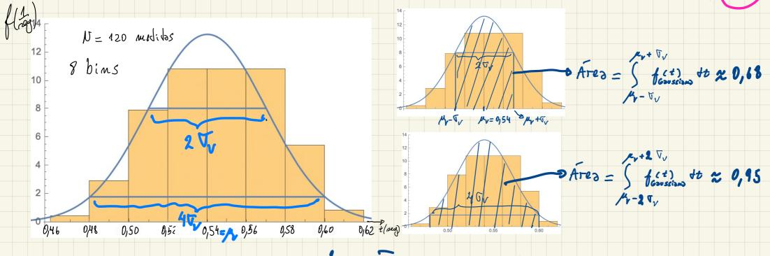
Wotern que mo exemplo t = 0,538917 ~ 0,54 = py c √≈ 0,0289246≈ 0,03= √v Assim no intervato [t-6, t+v] espero-se en contror um resulto lo de medido com 68% de probabilitable e no intervalo[£-20, 5+25] com 95% de probabilidade e no intervalo [ = -35, = +35] com 99 % de probob: Li dade!!!
